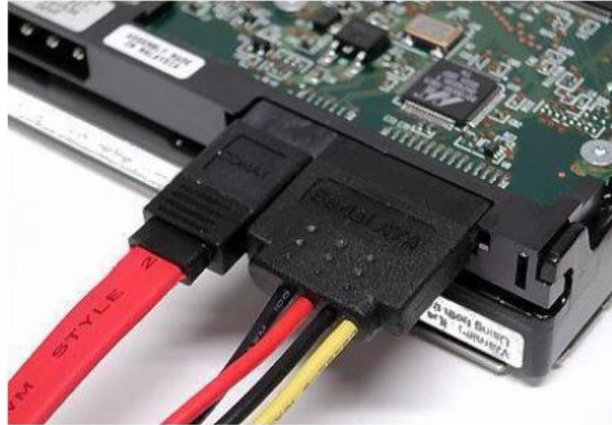
Şekil 8.12. Veri akışını sağlayan SATA kablo ve Güç kablolarının bağlantı şekli
